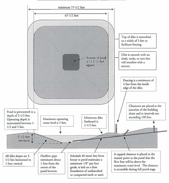
Figure C THE LARGER SINGLE-FAMILY WASTE STABILIZATION POND
